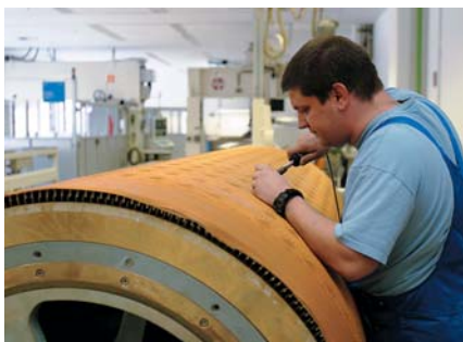
Wasserzeichen marsch: Am Rundsieb ist exaktes Arbeiten gefragt.
